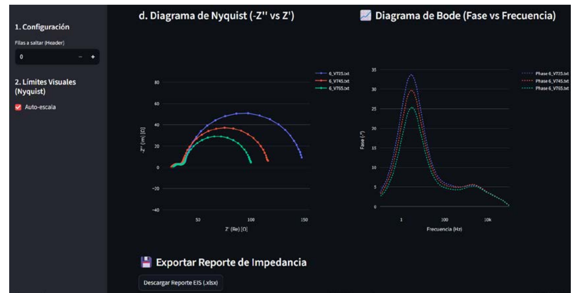
Figura 2. Módulo de análisis que genera automáticamente distintos tipos de gráficas eléctricas.
