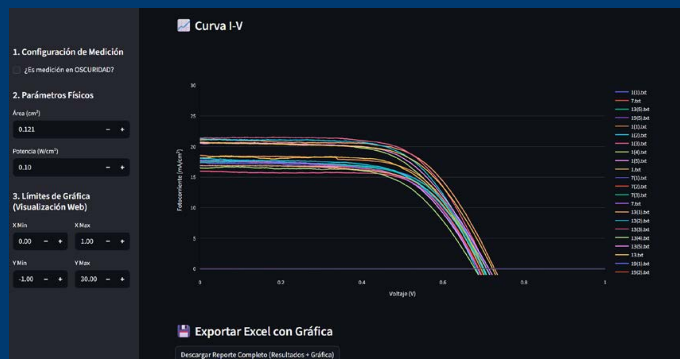
Figura 1. Interfaz de la aplicación desarrollada para generar curvas de corriente-voltaje.
