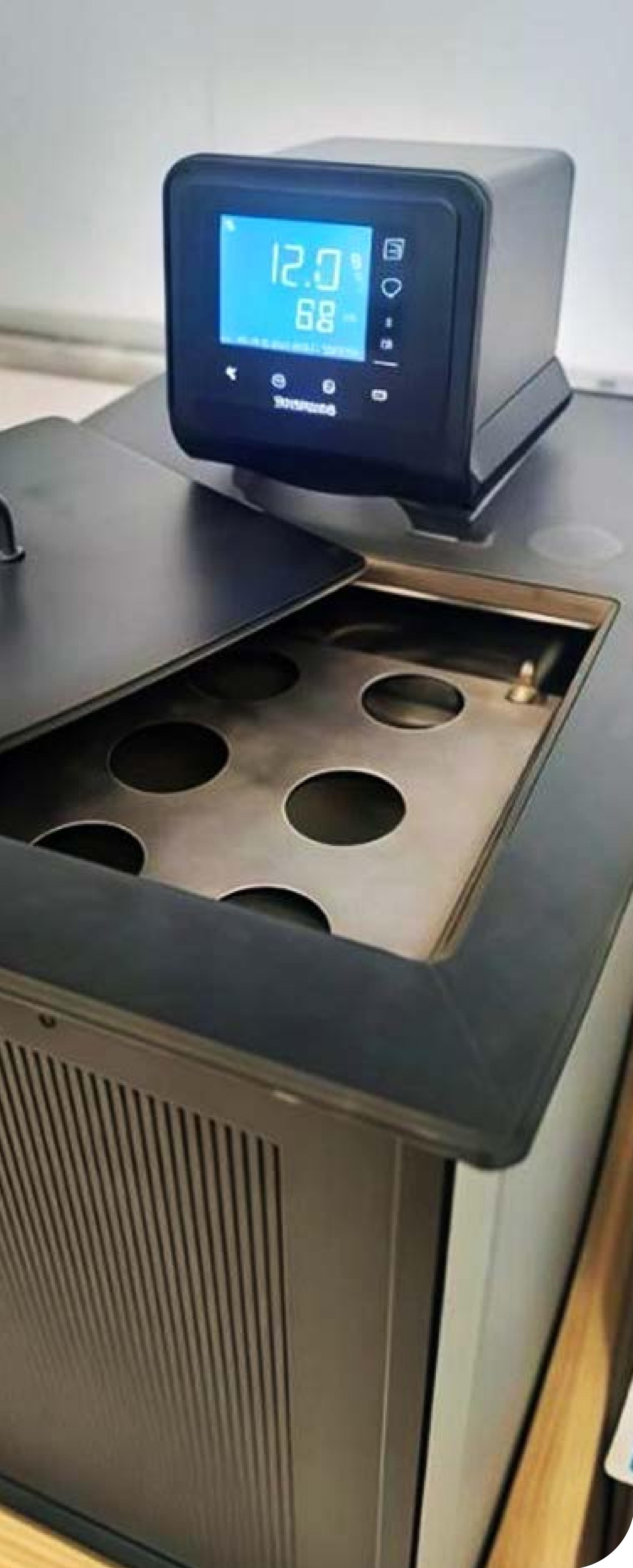
Fig. 2. Recirculador automático para el depósito por baño químico de CdS.
