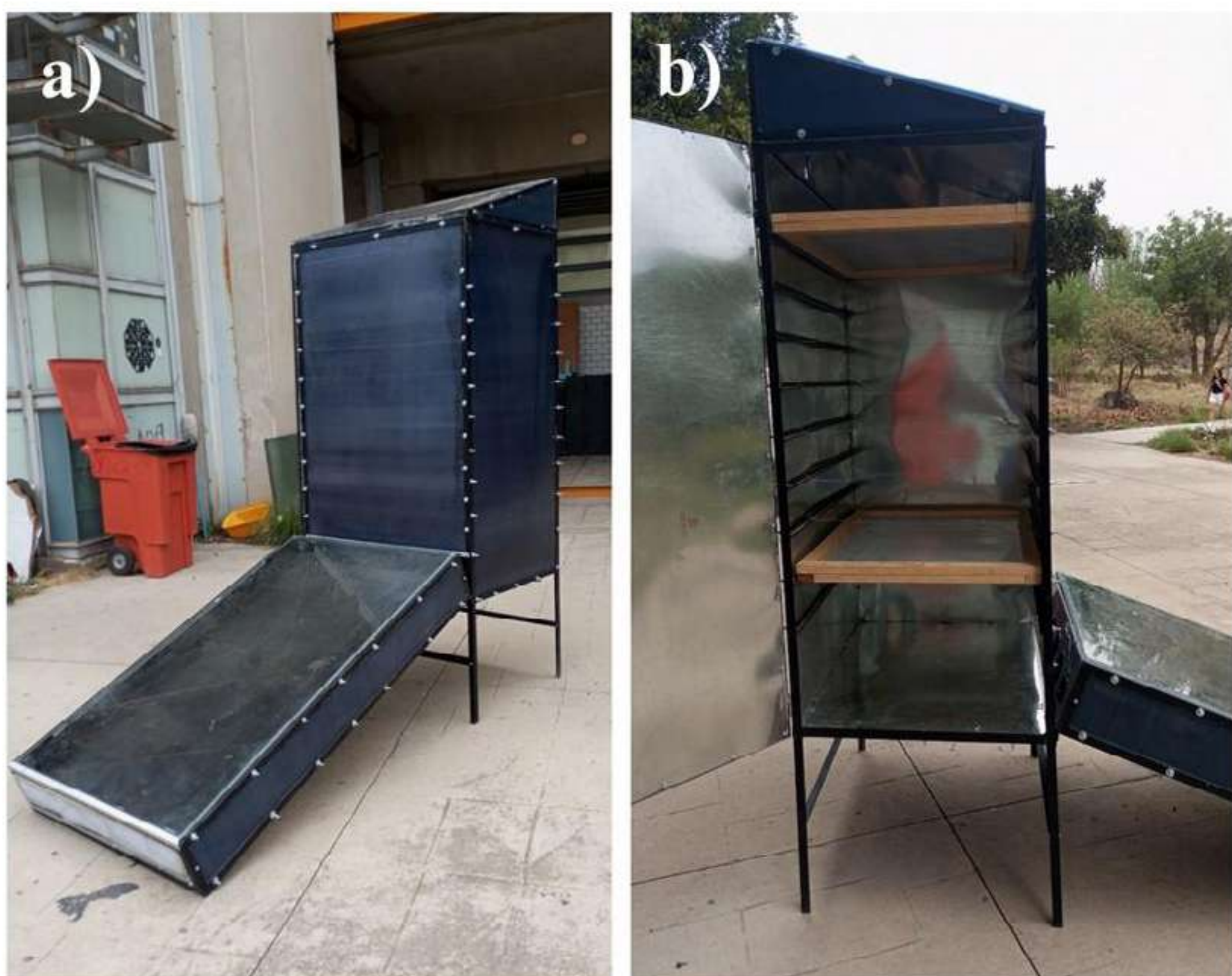
Figura 2. Secador solar de tipo indirecto: a) vista lateral y b) interna.
